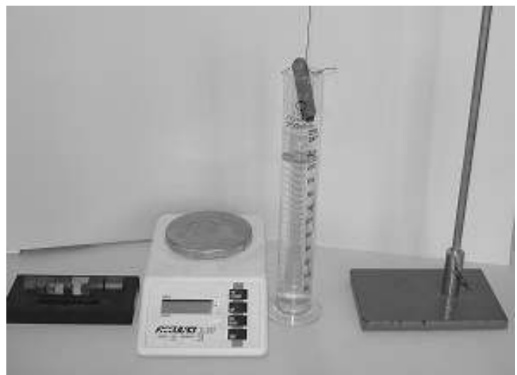
Όργανα και υλικά για την μέτρηση της πυκνότητας της πλαστελίνης
