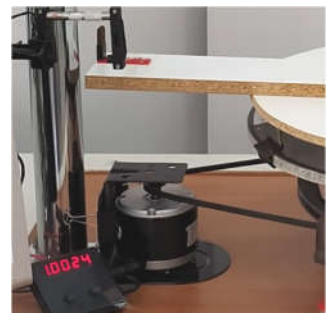
Εικόνα 3: Το μοτέρ, ο ιμάντας περιστροφής, η φωτοπύλη και το χρονόμετρο, ο πύρος.
