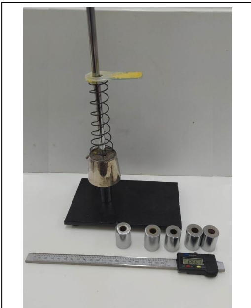
Εικόνα 2: Διάταξη για την εύρεση της σταθεράς του ελατηρίου συμπίεσης.
