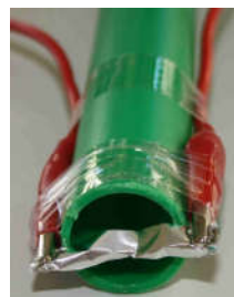
Σχήμα 6: Η ταινία αλουμινίου – διακόπτης
